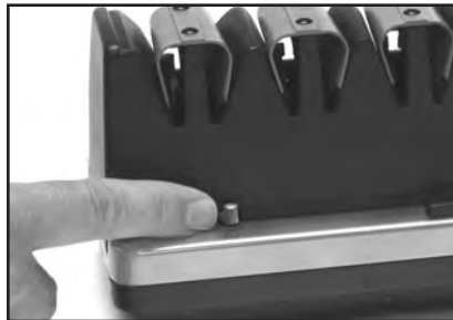
Kuva 15 Vaiheen 3 laikkojen puhdistuksen ja kunnostuksen ohjauspainike.
