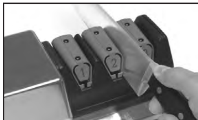
Kuva 9 Veitsen asettaminen oikeaan hahloon.
