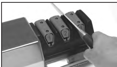
Kuva 8 Veitsen asettaminen vasempaan hahloon.
