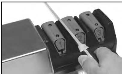
Kuva 8 Veitsen asettaminen vasempaan hahloon.
