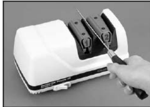
Kuva 6 Terän vieminen 2. vaiheen vasempaan hahloon. Vedä terää vuorotellen vasemman ja oikean hahlon läpi.
